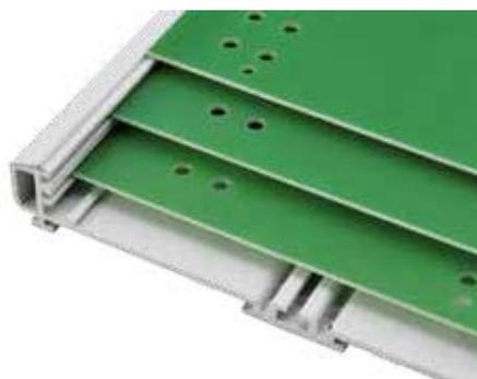
Per il montaggio dei PCB sono disponibili tre livelli di posizionamento. I due PCB inferiori vengono inseriti in apposite scanalature guida, mentre quello superiore viene fissato al profilato mediante elementi di fissaggio.
