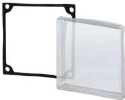
Per la tenuta del frontalino della custodia e dell'interfaccia tra custodia e pannello sono disponibili relative guarnizioni quali optional. L'impiego di coperchi trasparenti flessibili in PVC consente l'azionamento diretto di pulsanti e interruttori senza per questo dover aprire il coperchio e garantendo così il grado di protezione IP65.
