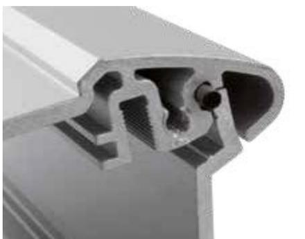
Per ottenere il grado di protezione IP54 dovrà essere montata dal costruttore, oltre alla guarnizione AT...DI disponibile quale accessorio, anche una guarnizione a corda o-ring inserita nel profilato della custodia.
