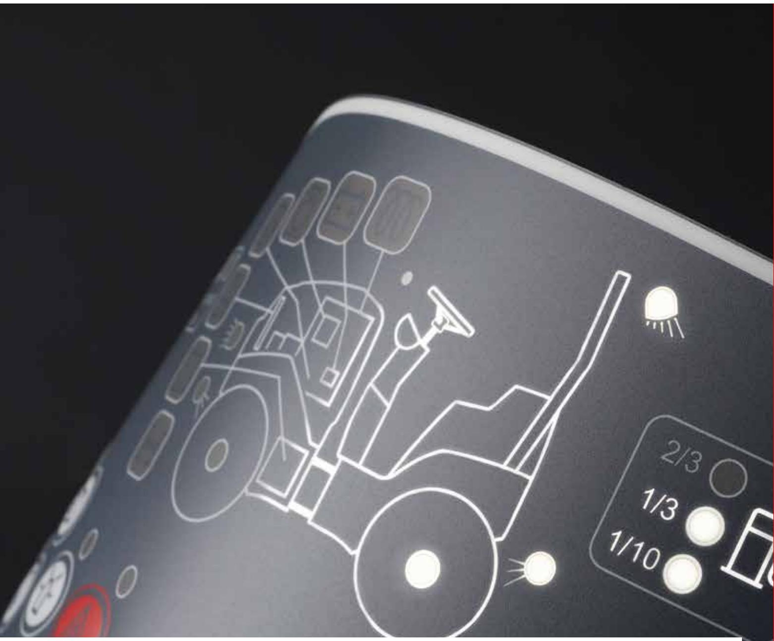
**La membrana frontale rappresenta l'interfaccia visiva e tattile tra la vostra tastiera a membrana e l'utilizzatore. L'aspetto estetico e grafico può essere realizzato e curato mediante diverse tecniche di stampa e di embossing.**
