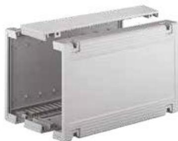
L'altezza delle custodie può essere variata di 15,24 mm (3 HP) o di 45,72 mm (9 HP) con l'uso di appositi set di espansione. Combinando adeguatamente questi set di espansione è possibile ottenere variazioni graduali di altezza di 15,24 mm (3 HP).
