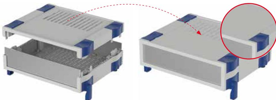
Questa custodia da tavolo è composta da due gusci in plastica e da piastre frontali in diversi materiali. Ruotando reciprocamente di 180° i gusci nella versione dotata di feritoie di ventilazione, è possibile ottimizzare il ricambio d'aria all'interno della custodia.
