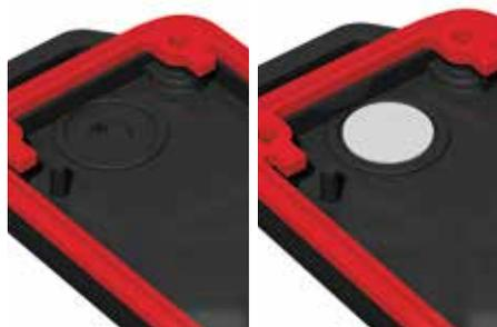
Compensazione della pressione mediante montaggio della relativa membrana DAE-D11. Per montare la membrana è necessario eseguire un foro (mediante trapano o altro attrezzo simile) nell'alloggiamento predisposto nella custodia e fissare la membrana mediante incollaggio.
