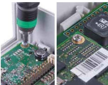
Se realizzati di conseguenza, è possibile il bloccaggio a scatto dei PCB. Fissaggio di PCB sui gusci inferiori e superiori.
