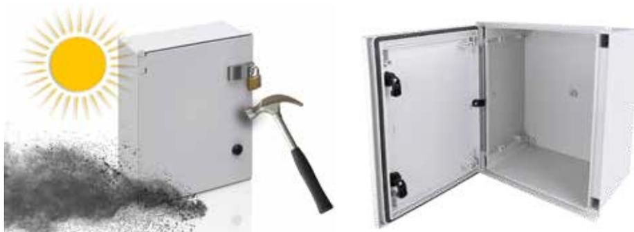
La custodia Polysafe è realizzata in poliestere rinforzato con fibra di vetro e offre una resistenza meccanica estremamente elevata agli agenti chimici e ai raggi UV. Tutti i componenti esterni sono realizzati in plastica – ciò riduce al minimo il rischio di corrosione.
