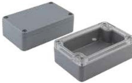
La guarnizione in espanso iniettata produce un elevato grado di protezione. Una maggiore resistenza termica può essere ottenuta, in alternativa, con l'uso di una guarnizione siliconica. Su richiesta, è disponibile anche una speciale versione EMC che consente un collegamento conduttivo tra coperchio e guscio inferiore.
