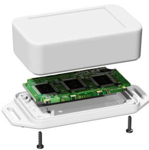
Eine 1,6mm starke Platine kann direkt zwischen die Gehäuseteile geklemmt und optional über 2 Stifte heißverstemmt werden.
