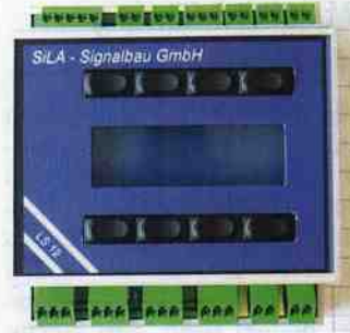
Im Display der Frontplatte der Steuerung wird der Zustand der Schrankenanlage abgebildet
