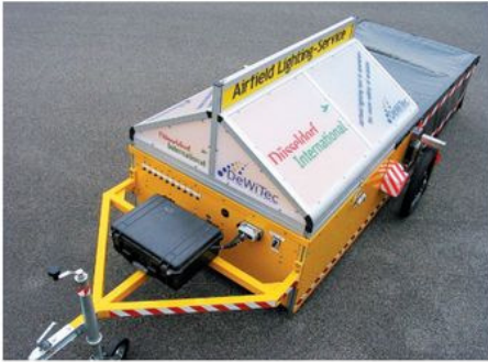
Das Befehrsanalysegerät Dalmas erkennt Defekte und Verschmutzungen an den „Feuern“
