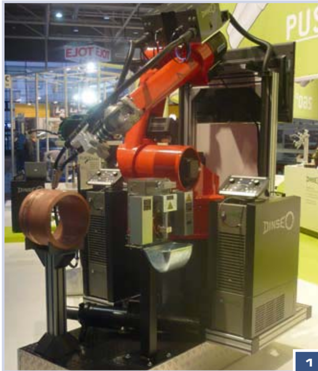
Bild 1. Der Power Inverter DIX PI 400/500/600 ist eine Stromquelle für das MIG-/MAG-Schweißen. Deren Herzstück ist die zentrale Steuereinheit, die den Schweißprozess überwacht. Die Bediengeräte PR 100E sind links und rechts vom roten Roboterarm zu sehen
